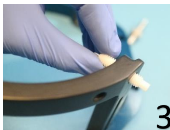
Figura 1-19: Inserción del tornillo interno
